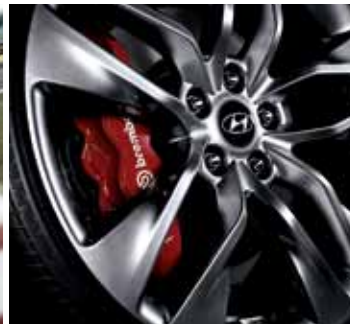
대용량 고탄소 브레이크와 마찰재를 적용해 제동성능이 우수한 전/후륜 4피스톤 브레이크 시스템
